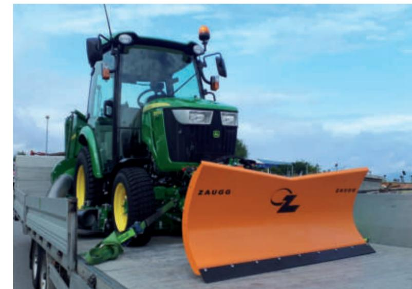
Ce véhicule neuf, fiable, est mieux adapté aux besoins de nos deux villages. Il est notamment utilisé pour la tonte, la scarification, l'épandage d'engrais, le nettoyage des surfaces (routes, trottoirs, parking, etc.), le service hivernal (déneigement et salage des trottoirs), l'arrosage des décorations florales ainsi que pour d'autres tâches comme le transport par exemple. Pour ce faire, le riche équipement standard du véhicule a été complété avec les agrégats suivants :
